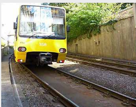
Koľajové vozidlá DT8 Stuttgart v úseku so systémom Hmota-pružina v oblúku (R90) na rampe (70 ‰)
