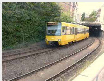
Koľajové vozidlá DT8 Stuttgart v úseku so systémom Hmota-pružina v oblúku (R90) na rampe (70 ‰)
