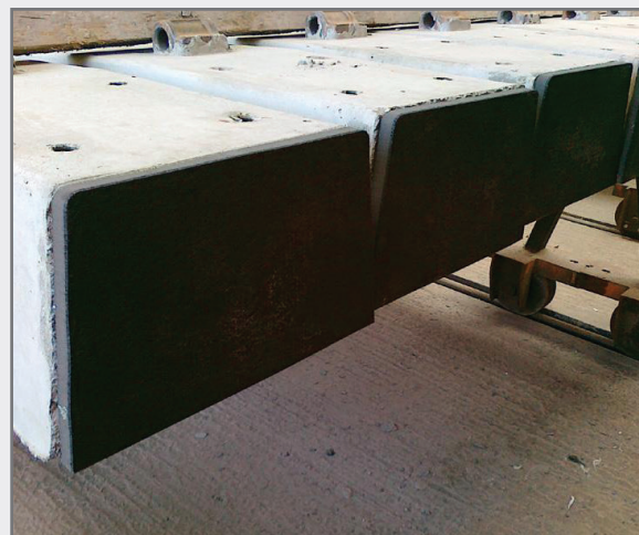
10 Obr. č. 10: Betónový podval s podpodvalovou podložkou a pružným bočným čelom (vľavo: 3D vizualizácia, vpravo: detail vyrobených podvalov).
