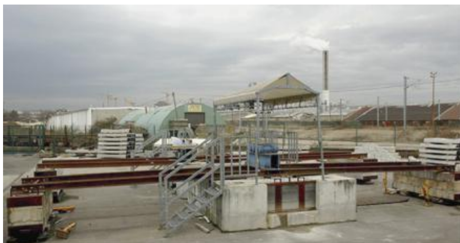
Obrázok 1-13 Testovanie únavovej odolnosti podpodvalových podložiek pomocou testu Vibrogir so simulovaným zaťažením 400 mil. hrt
