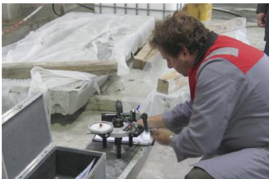
Obrázok 1-14 Stanovenie prídržnosti podpodvalovej podložky k podvalu na kruhovej časti podložky pri d = 50 \text{ mm}
