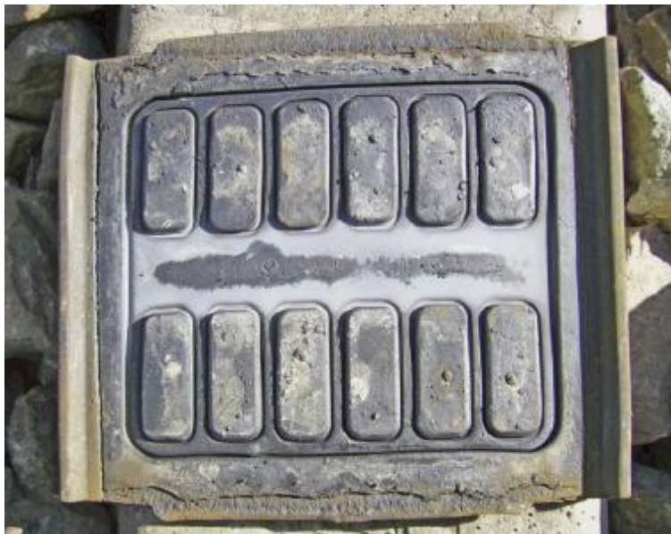
Obrázok 1-22 Demontované podložky pod pätu koľajnice sú takmer bez opotrebovania
