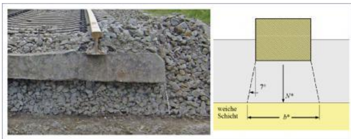
Obrázok 1-4 Uhol roznosu zaťaženia v koľajovom lôžku a pri výpočte odolnosti podložia
