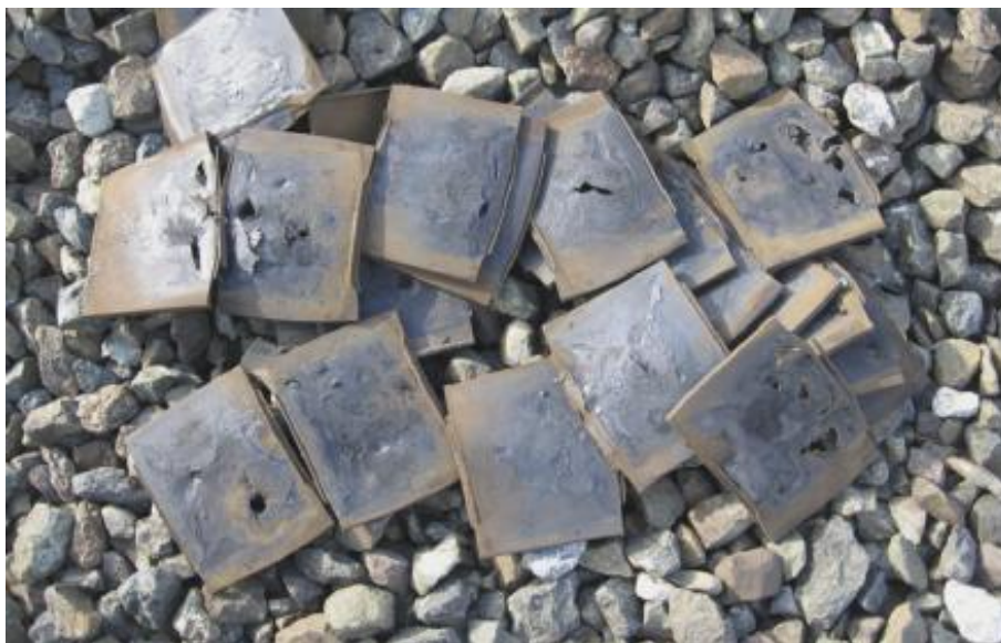
Obrázok 1-7 Odstránené opotrebované podložky pod päť koľajnice z trate na betónových podvaloch
