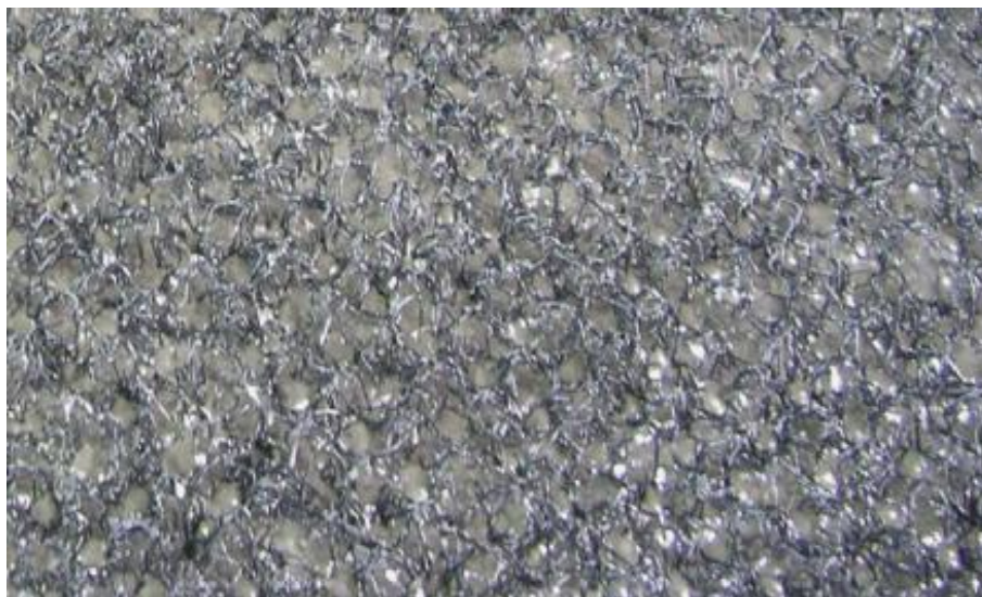
Obrázok 1-12 Plastová mriežka ako kontaktné médium pre podpodvalové podložky
